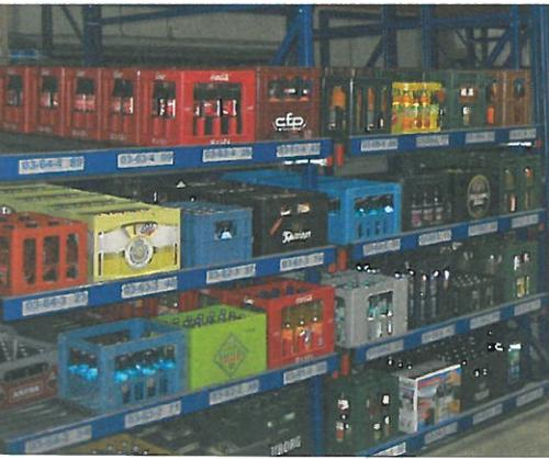
*Einsatz integrierter Rollenbahnen zur optimierten Kommissionierung von Kleingebinden*
