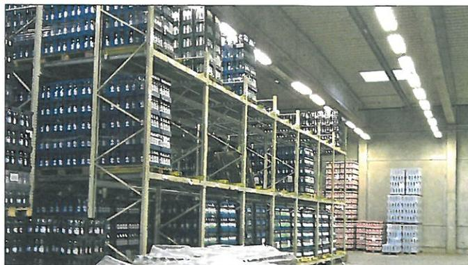
*Die Kombination von Kommissionierzonen in den ebenerdigen Kanälen und Lagerorten für Elo- und Tetra-Pack-Paletten in den oberen Kanälen bietet erhebliche Produktivitätsvorteile bei gleichzeitig optimaler Flächen- und Raumnutzung.*
